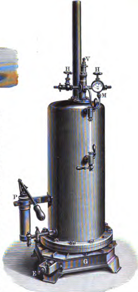
Dampfkessel für Gasfeuerung. (Höhe ohne Brenner und Schornstein \frac{3}{4} m, Durchmesser im Lichten 300 mm, außen etwa 400 mm.) P Speisepumpe, M Manometer, V Sicherheitsventil, HH Dampfausströmungshähne, G Gasbrenner, E Einstromungsöffnung für Gas.
